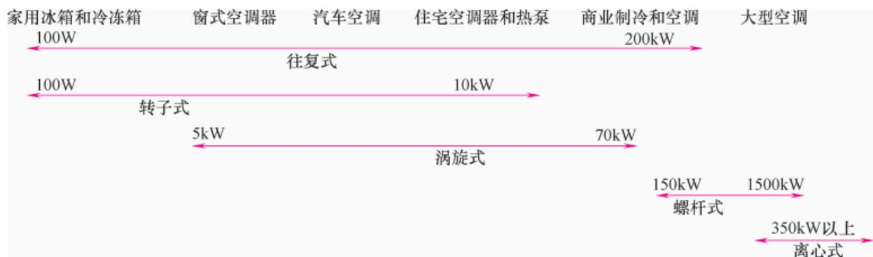
图 1-16 目前各类压缩机的大致应用场合及其制冷量大小
